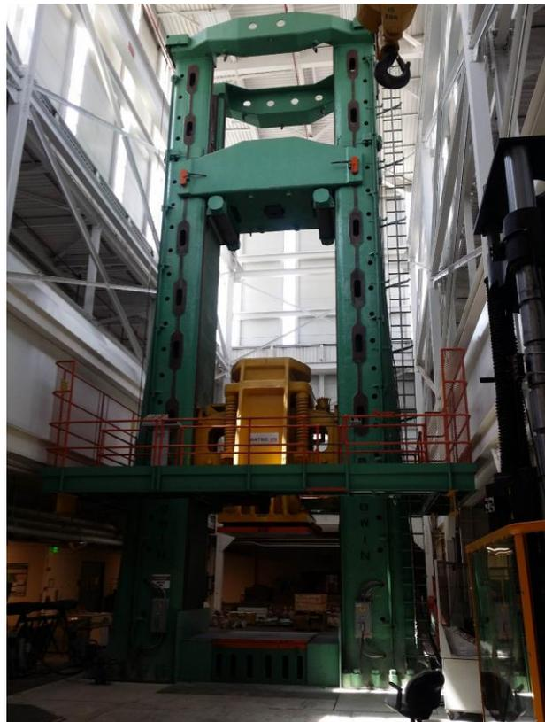
大型混凝土抗壓試驗設備
