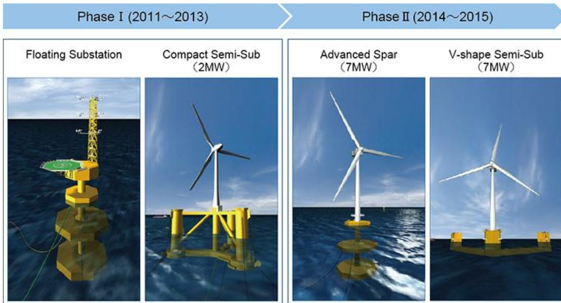
圖二 漂浮式基礎結構型式
