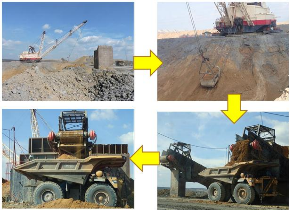
圖66 Drummond礦區Dragline覆土移除作業
