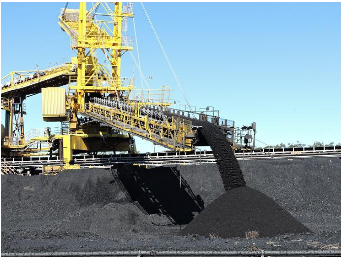
圖38 PWCS堆煤機堆煤作業
