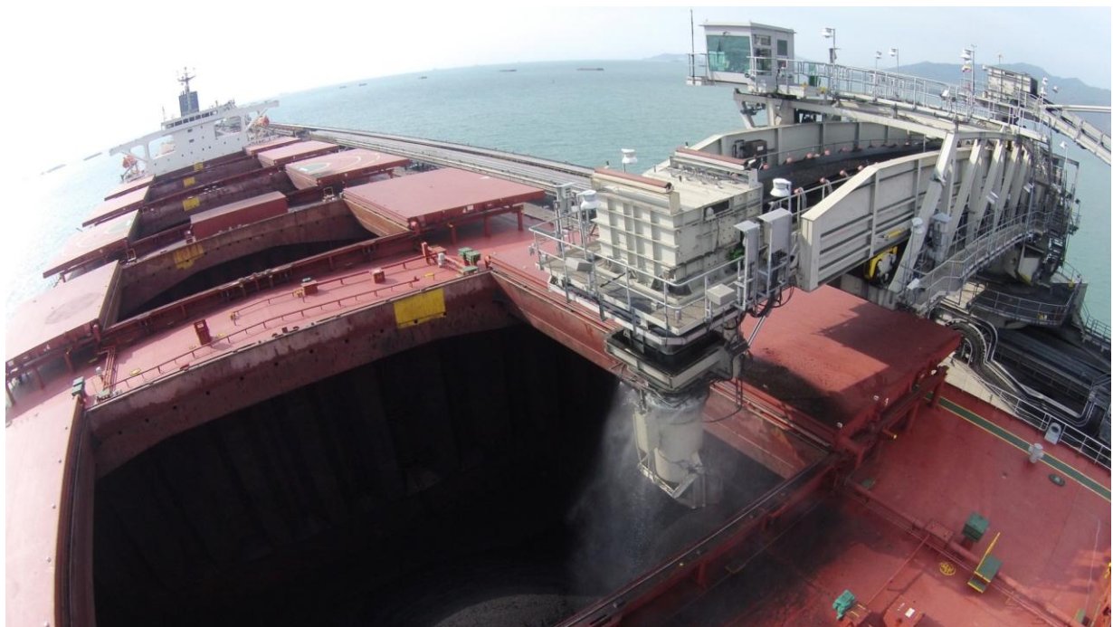
圖113 Puerto Drummond Shiploader粉塵抑制系統
