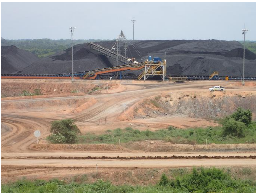
圖133 Prodeco礦區堆煤機堆煤作業
