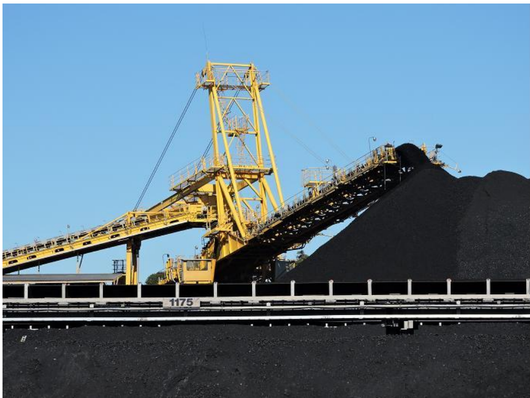
圖39 PWCS堆煤機堆煤作業
