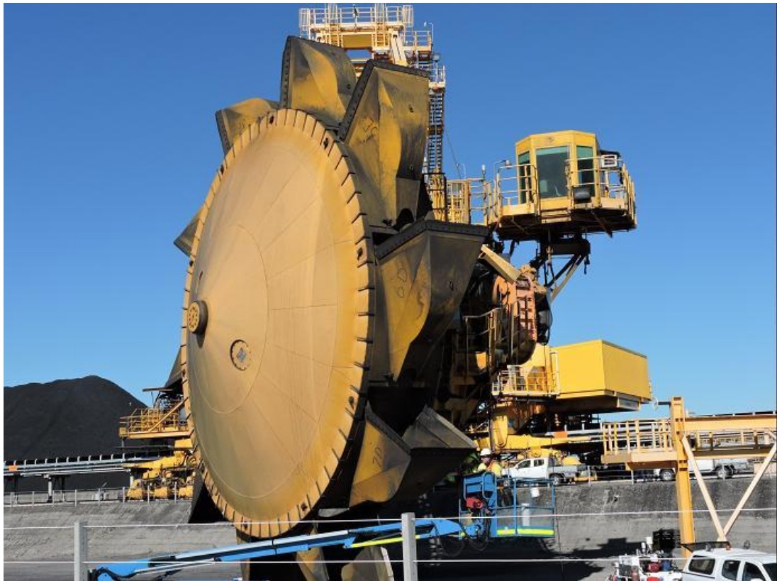
圖43 PWCS斗輪式堆/取煤機抓斗維修作業
