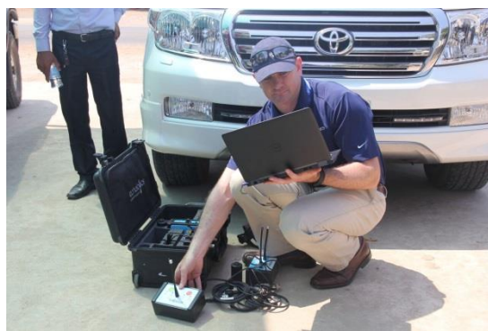
圖 33 加拿大 Echologics 之 EchoWave® 檢測示意
