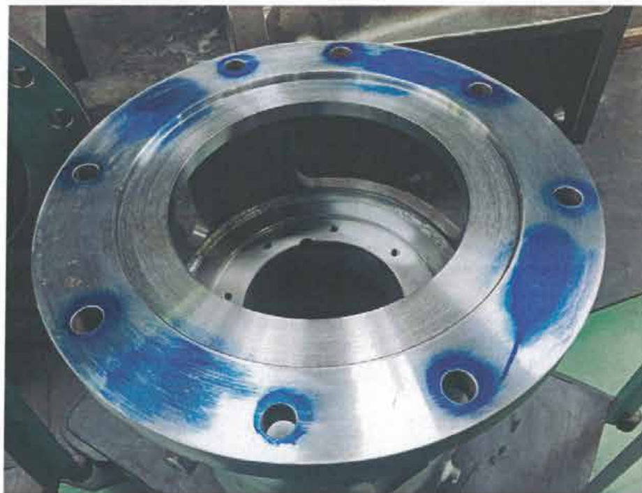
法蘭表面施作液滲檢測
