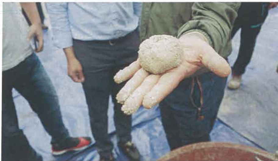
耐火泥手握成形，泥球不可散開，方可施作
