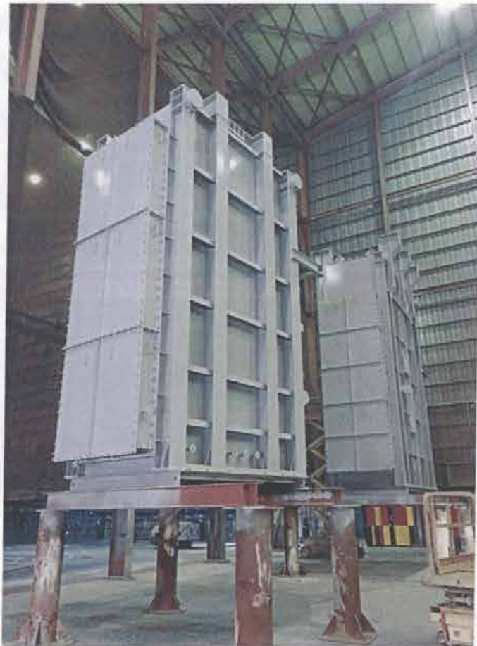
本案加熱爐對流區噴砂油漆中
