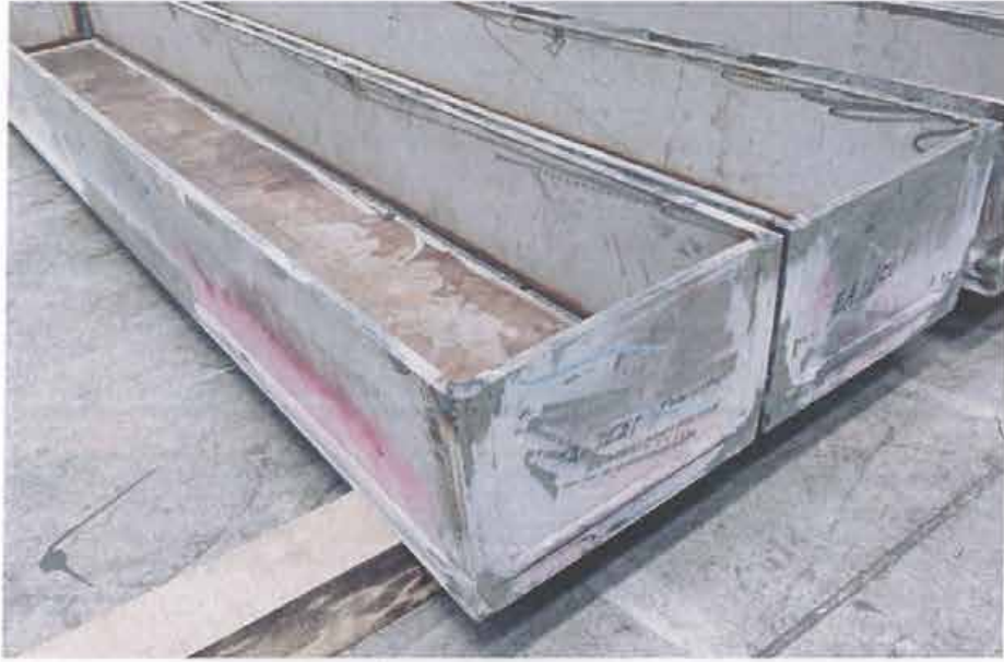
Air Cooler 空冷器 Header 銲道液滲檢查
