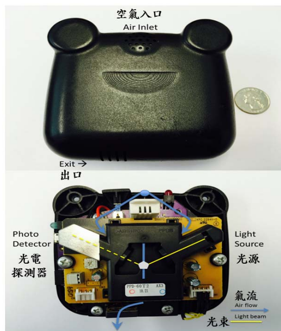
圖 3、AirBeam 外觀與內部構造示意圖
