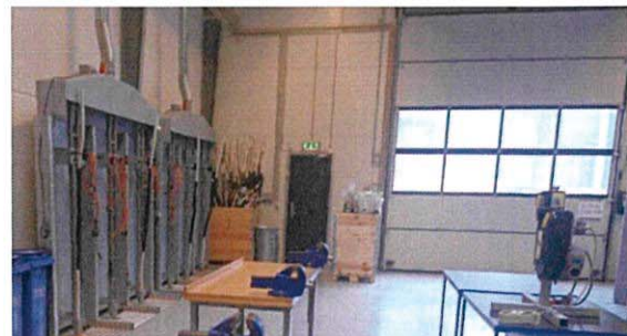
圖 17 海纜與風機內電纜接續訓練設備
