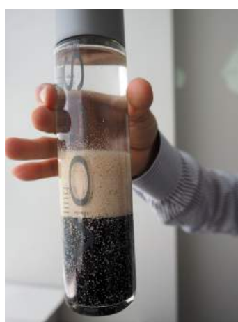
圖 18. 冷凝水淨化系統所使用的離子交換樹脂型式
