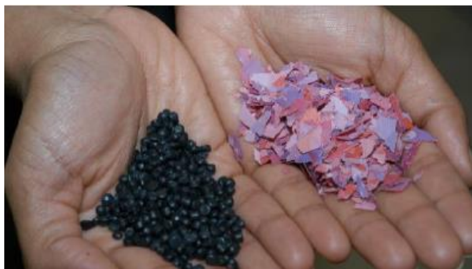
圖 27 以塑膠銷毀券製成的顆粒狀材料
