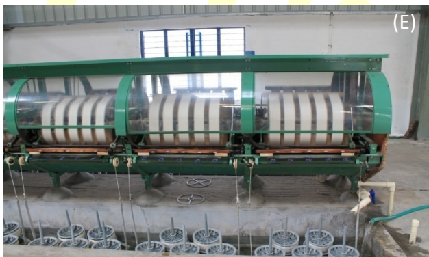
圖 12、自動縲絲工廠(A)收購來的蠶繭、(B)-(C)煮繭、(D)自動縲絲機械、(E)-(F) 楊返及生絲
