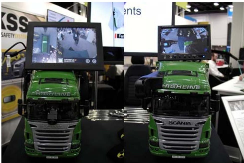
圖 27. KSS 全周影像系統(2D)-現場以模型車進行展示(包括前方視角盲點)
