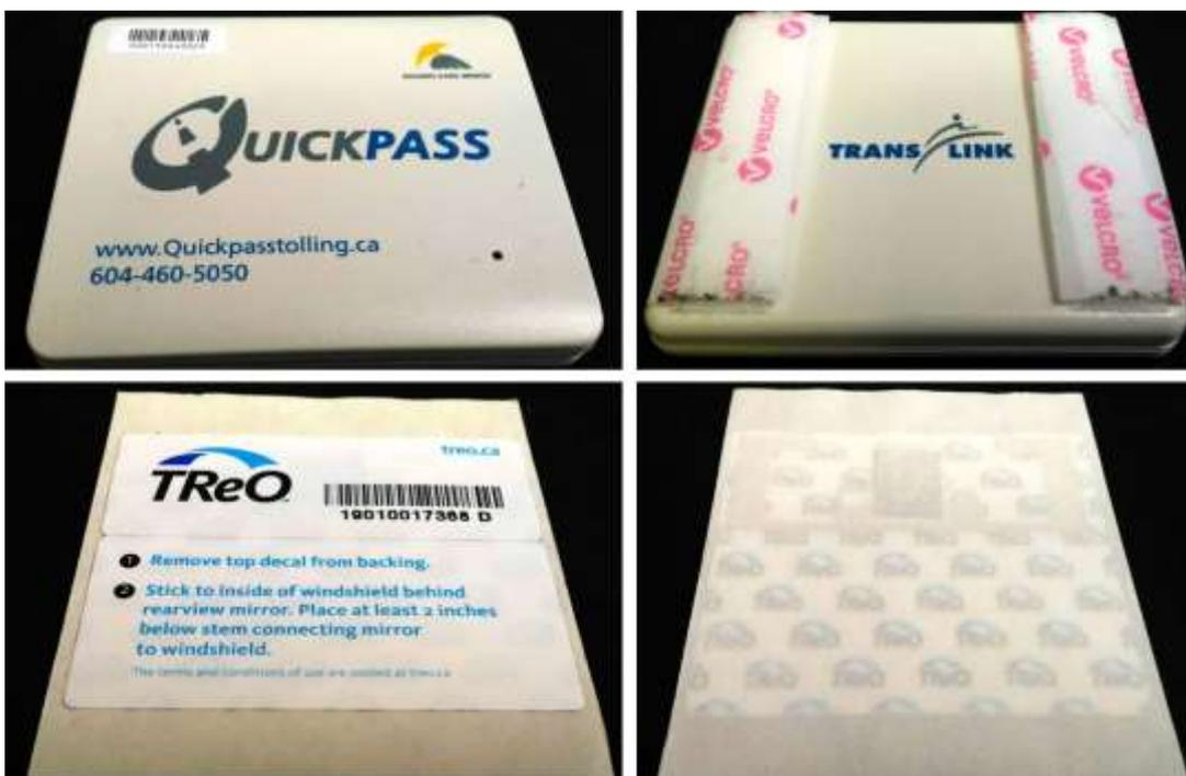
圖 13. Golden Ear 與 Port Mann 橋梁 ETC 之 QuickPass 詢答器與 Treo 電子標籤
