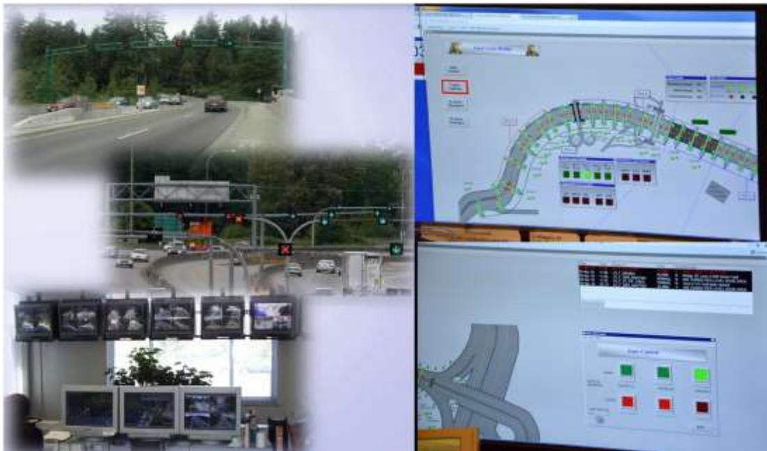
圖 32. BC 省區域交通管理中心 Lion Gate 橋梁的自動化調撥車道控制
