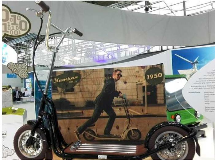
電動滑板車(16V、8.8Ah 鋰鐵電池)
