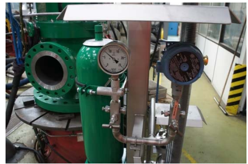
Plan 53B 軸封沖潤系統壓力正確。
