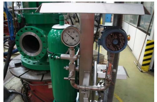
Plan 53B 軸封沖潤系統溫度正常。
