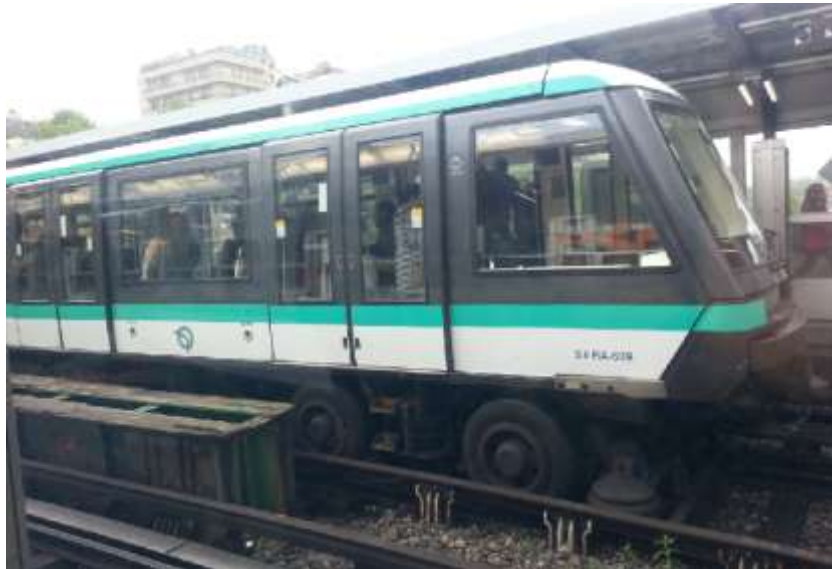
圖 4.44 巴黎地鐵 1 號線車輛圖(膠輪系統型式)
