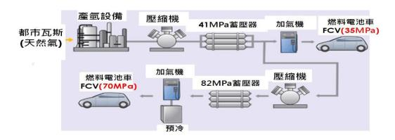
圖 14、日本千住加氫站以天然氣產氫供給燃料電池車流程
