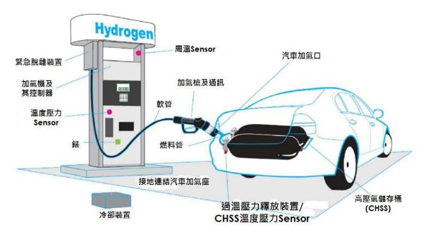
圖 3、加氫機與燃料電池車(FCV)的各元件裝置說明
