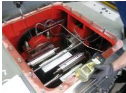
Main bearing 溫度測量
