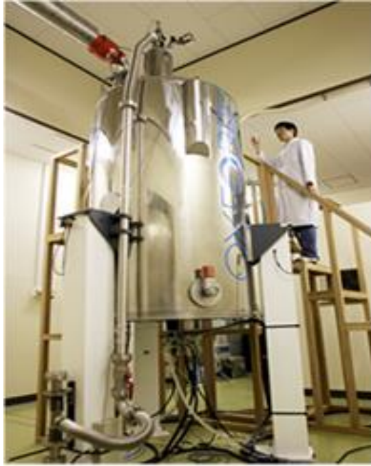
圖 11：核磁共振光譜儀（來源：NIHS 官方網站）
