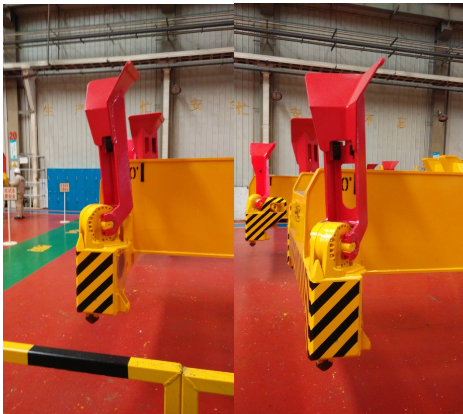
圖 2.4-8 高雄分公司吊具伸縮式吊具導板
