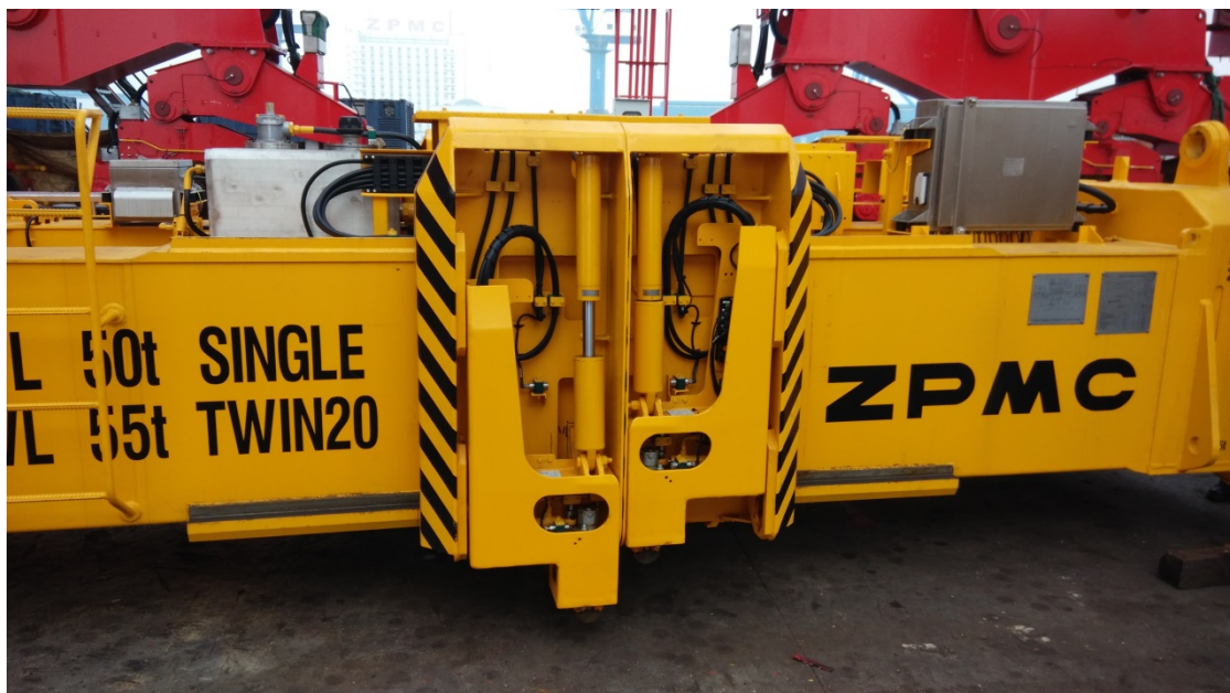
圖 2.4-5 基隆分公司伸縮式吊具
