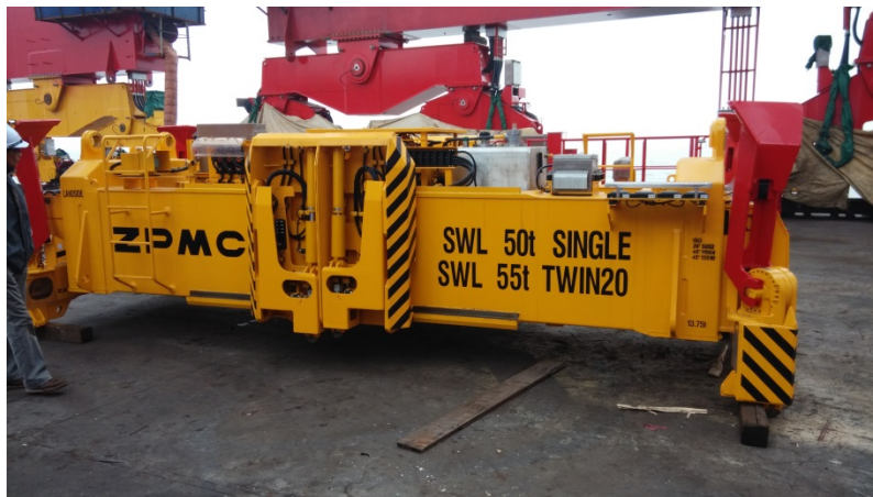
圖 2.2-13 基隆港吊具準備安裝過程
