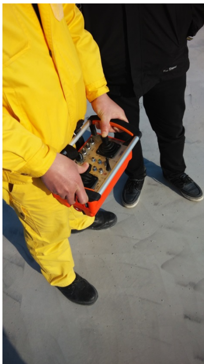
圖 2.5-3 操作人員持可移動式無線操縱器控制 AGV 移動
