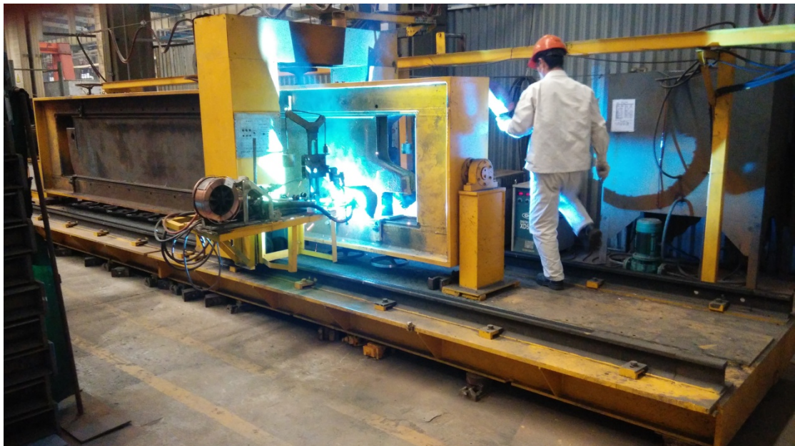
圖 2.4-2 鋼構由人員操作機器施焊#2
