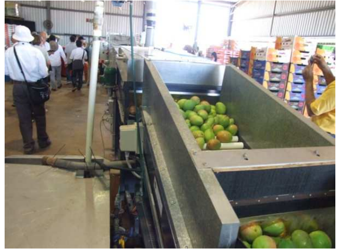
圖32. 利用滾輪裝置將果實運送至清洗槽中，再次進行清洗作業
