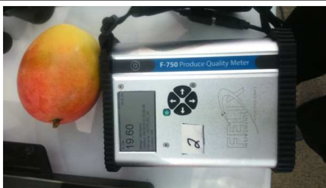
圖6. FELIX研發的非破壞性乾物質測定儀，可量測芒果乾物質含量，以判定其採收最佳時期，每台售價約1萬美金
