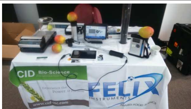
圖5. FELIX公司研發的葉面積測定儀、呼吸率測定儀、根系生長觀測系統與非破壞性乾物質測定儀，用於芒果的科學研究與生產
