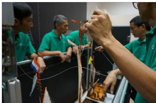
圖 9 以釣魚線固定 20:1 同安船模型，並以氣泡紙分隔釣魚線與船身。
