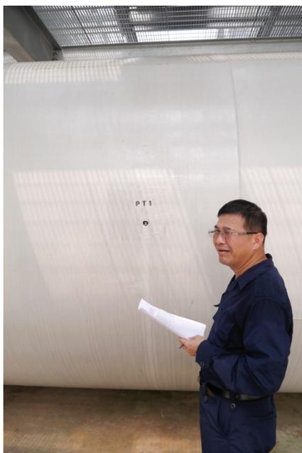
圖 54 模擬洩漏噴出之噴孔
