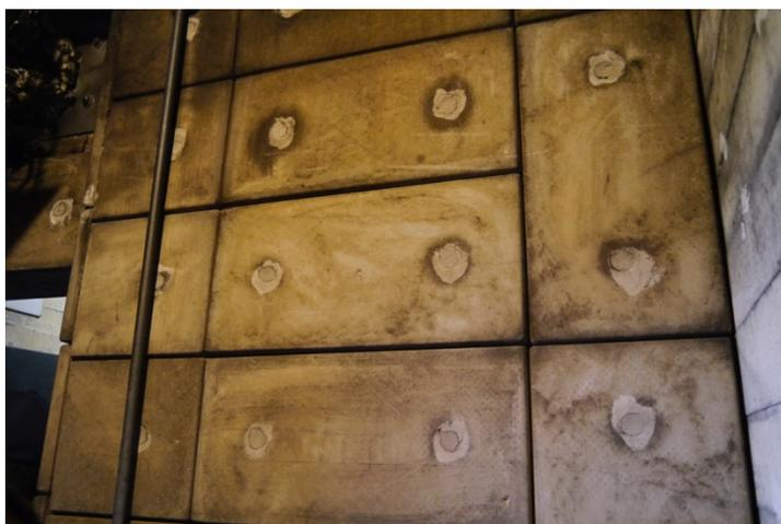
圖 52 建築結構實火模擬燃燒保護措施 1
