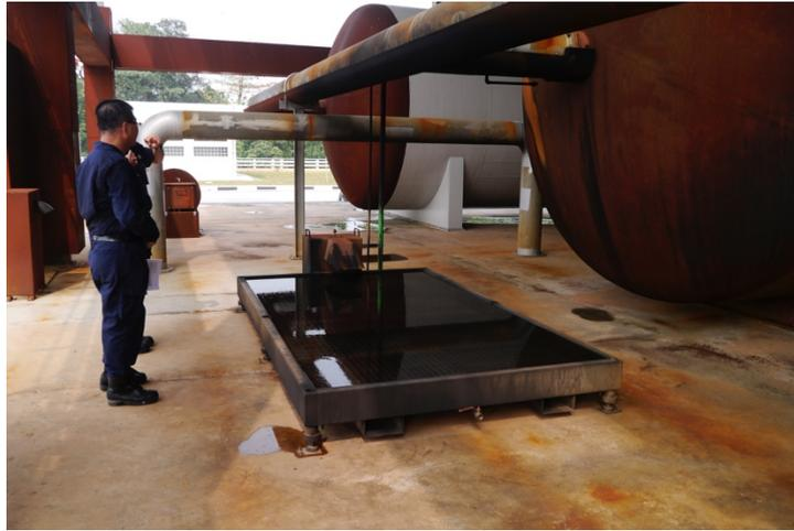
圖 18 輸送管線火災模擬
