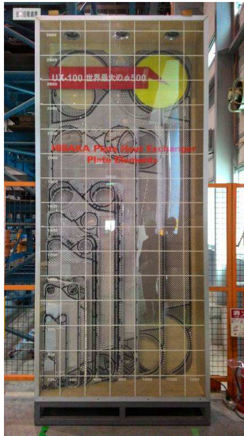
圖十、最大最有效率的板式熱交換器
