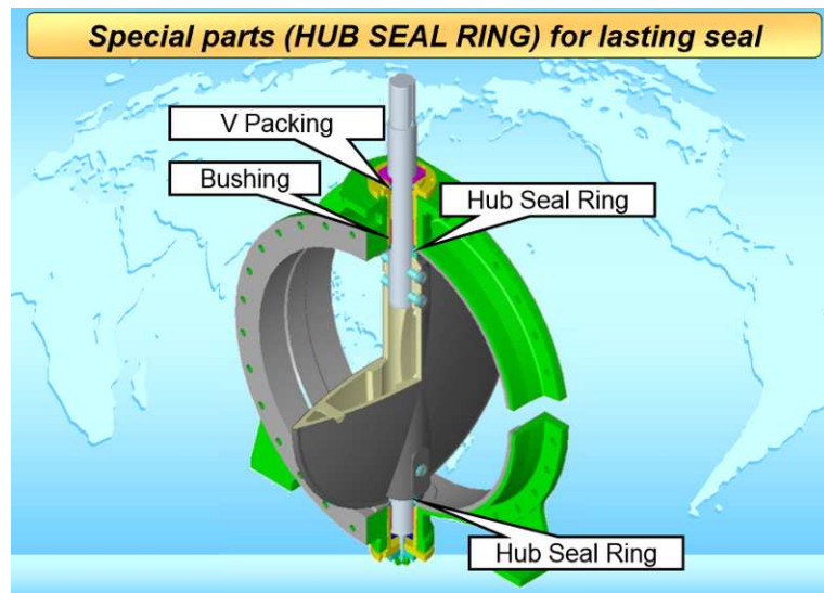
圖九、HUB SEAL RING 設計
