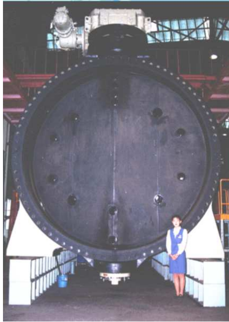
圖八、KUBOTA 最大型蝴蝶閥(直徑 4200mm)
