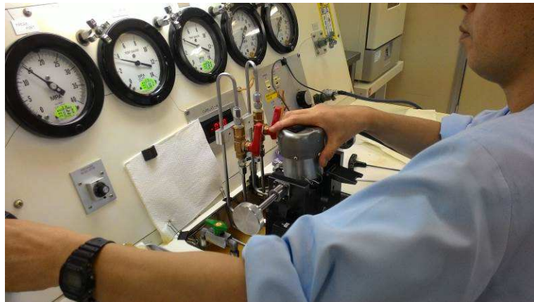
圖十二、伺服閥之電磁鐵磁力校正
