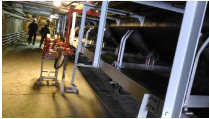
乾淨明亮的地下輸煤皮帶及快速消防水帶
