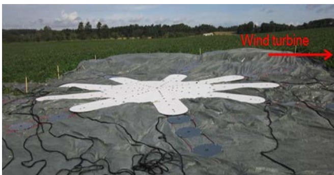
圖 5 麥克風陣列 (陣列尺寸 13.6 m×8.5 m 橢圓形星狀之麥克風陣列、麥克風數量 108 支)
