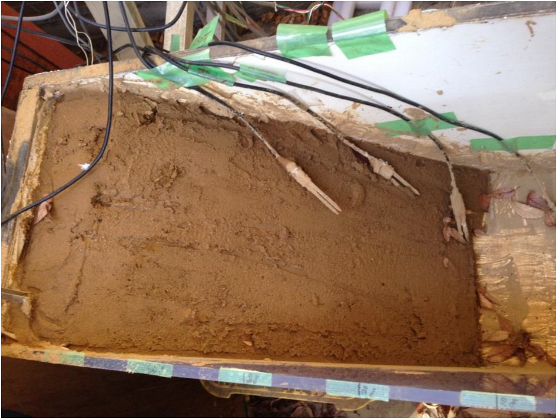
土壤試驗填築情形
