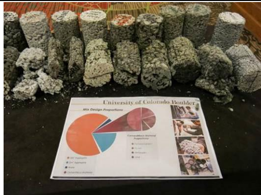
圖 12 透水混凝土競賽
