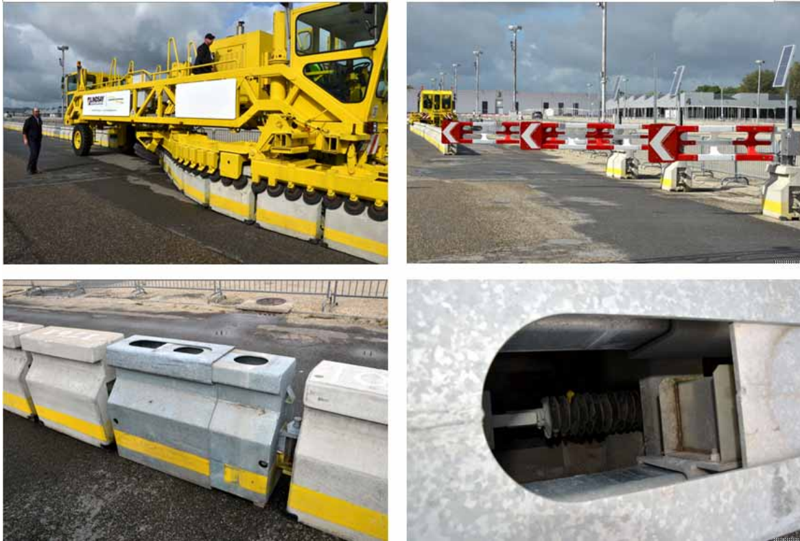
圖 22. Lindsay 公司拉鍊式的雙向不平衡車道分配類紐澤西護欄快速調整機具
