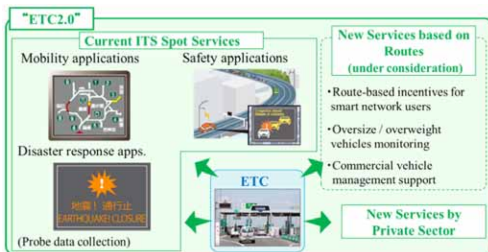
圖 32. 日本「ETC 2.0」概念示意圖
