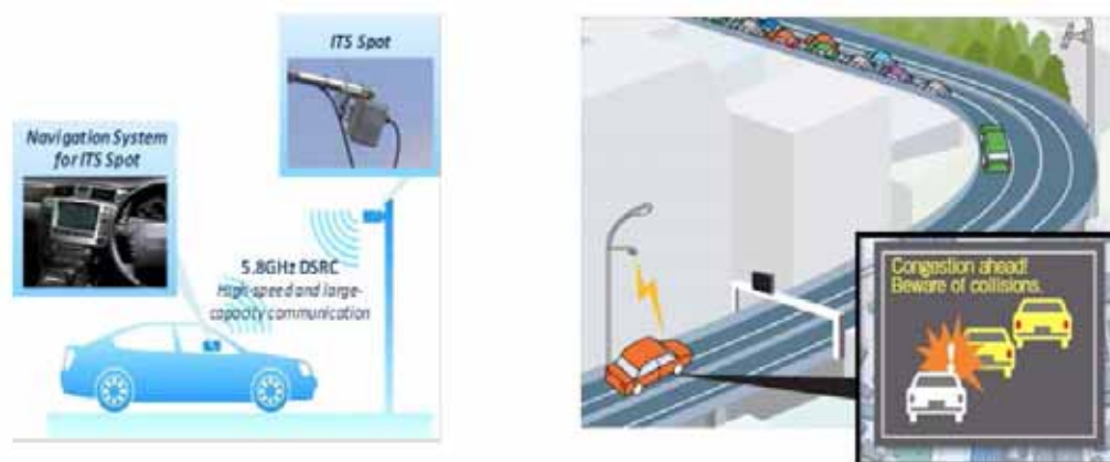
圖 31. 日本「ITS Spot」通訊與服務示意圖
