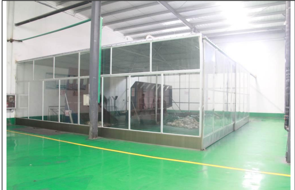
鑫中鑫生物科技有限公司原料區之透明罩(進料活動門位於圖右側)
