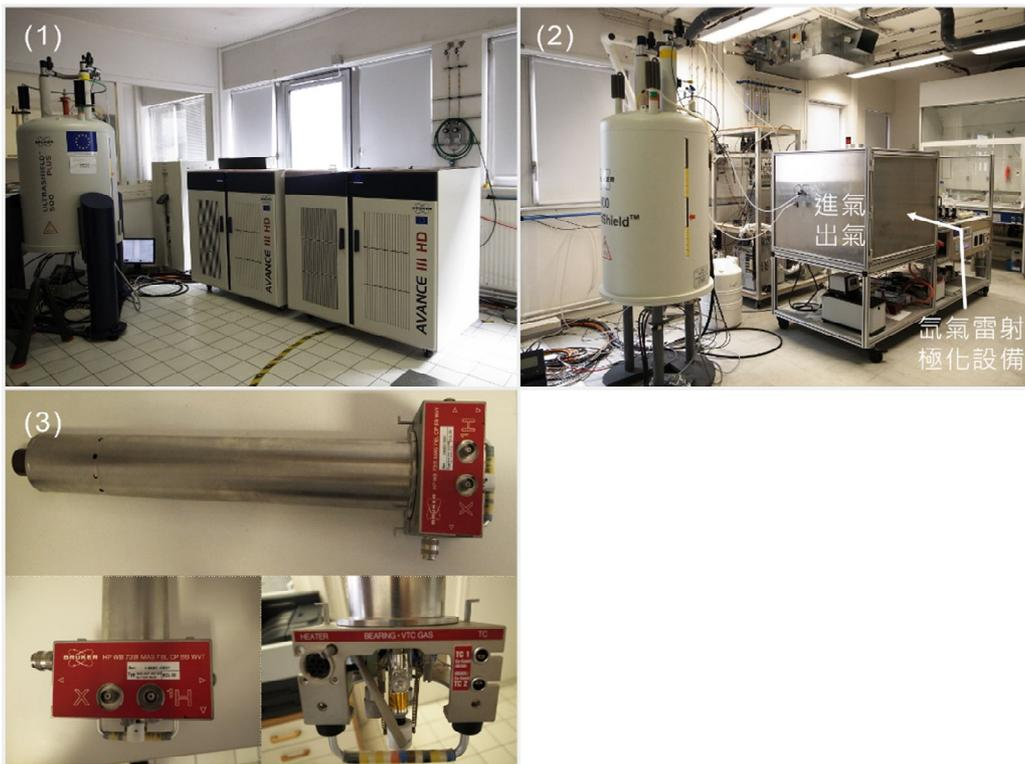
圖十五、(1) 測量觸媒即時反應之核質共振光譜、(2) Hussein El Siblani 博士開發之氫核 NMR 光譜儀設備、(3) 裝載觸媒樣品之固體探測頭。
