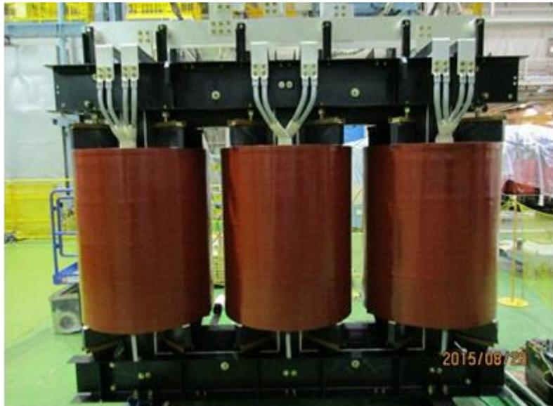
圖(十六-d)通霄新一機汽輪發電機激磁變壓器進行線圈阻抗量測
