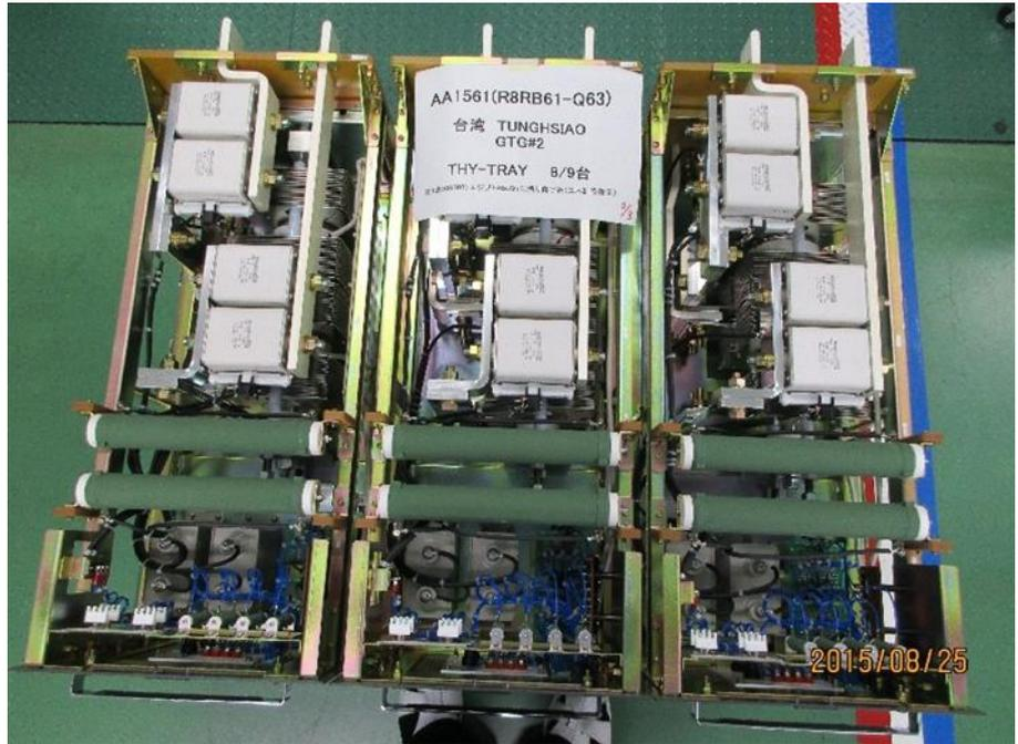
圖(十六-b)通霄新一機氣渦輪發電機 AVR 閘流體托盤
