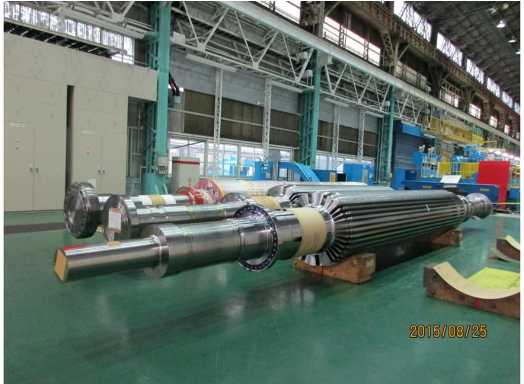
圖(三) 通霄新 1 機汽輪機發電機轉子於廠內組裝
