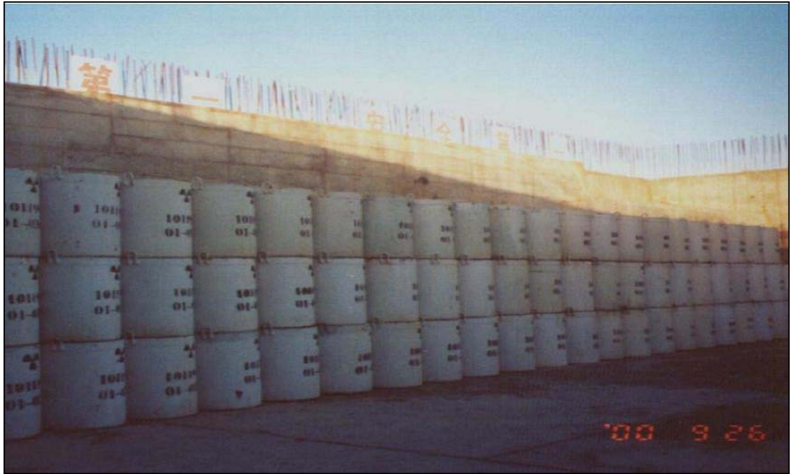
圖 10 西北處置場所堆置之中低放射性廢棄物混凝土桶
