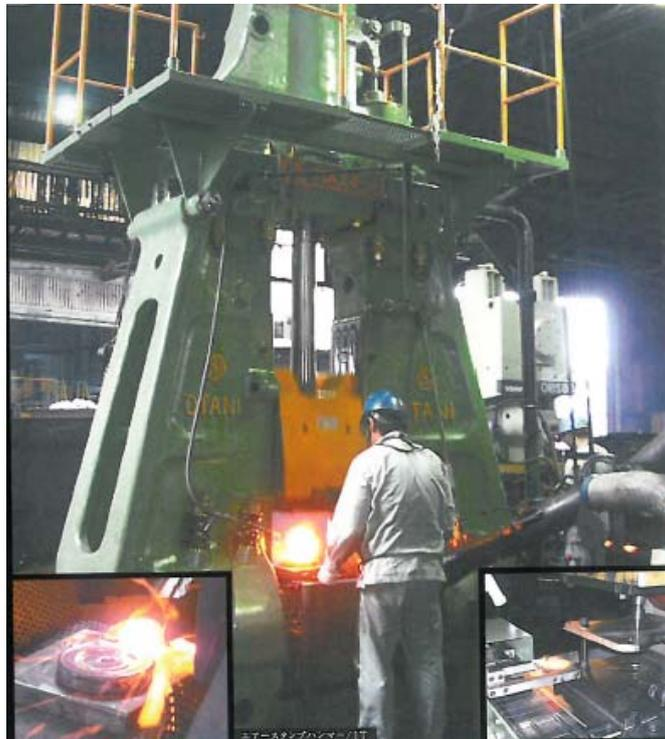
圖九 知多工業社所使用之落錘鍛機
