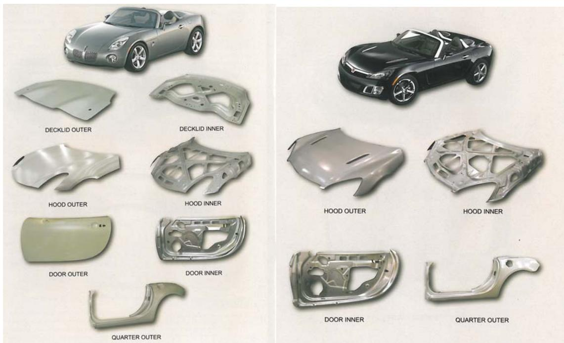
圖十六 液壓板金成型應用於汽車板金
