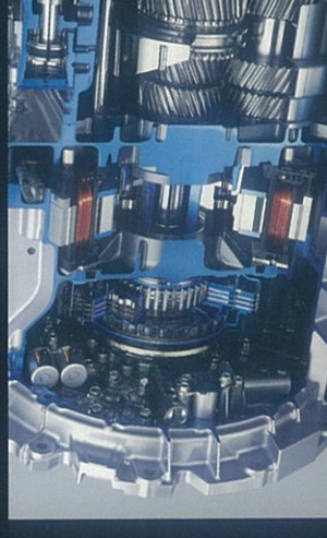
世界初のハイブリッド用モーター内蔵デュアルクラッチ式 トランスミッション The world's first dual-clutch transmission and hybrid motor
