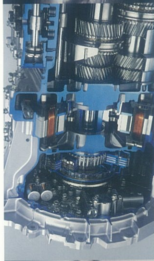
世界初の「ハイブリッド用モーター内蔵デュアルクラッチ式トランスミッション」 The world's first dual-clutch transmission and hybrid motor.
