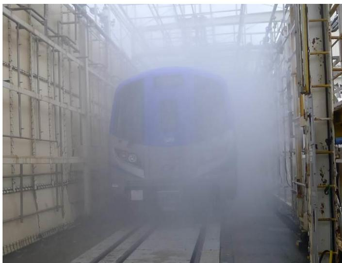
圖 3.13.1 水密測試車外噴水情形
