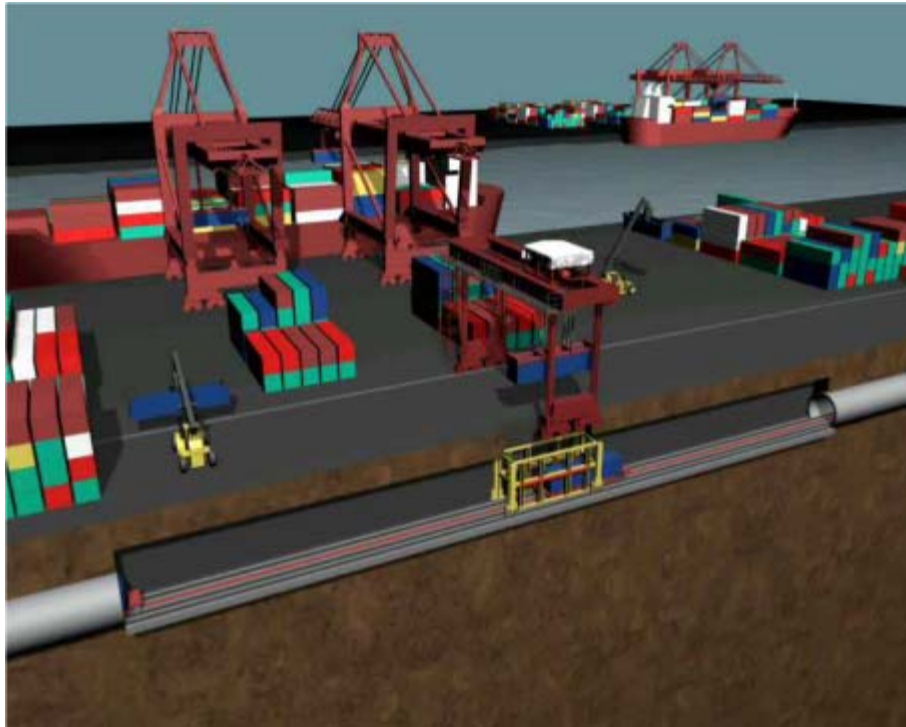
圖 18、隧道型火車裝載示意圖(課程講義)
