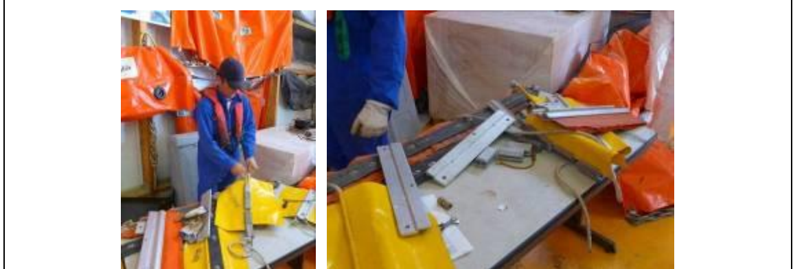
各種型式之攔油索連結構件
