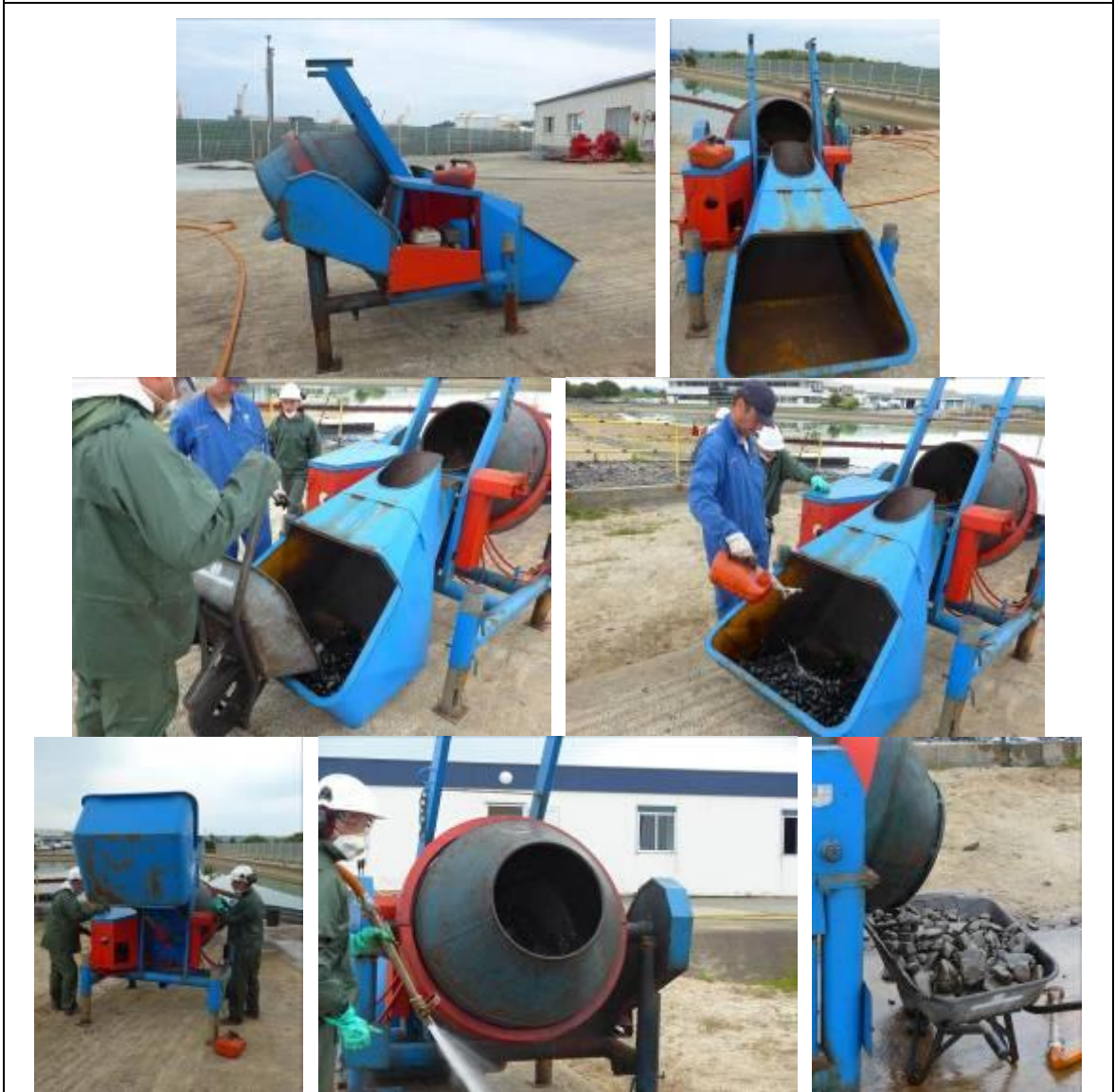
使用改良型攪拌機及清潔劑清洗礫石
