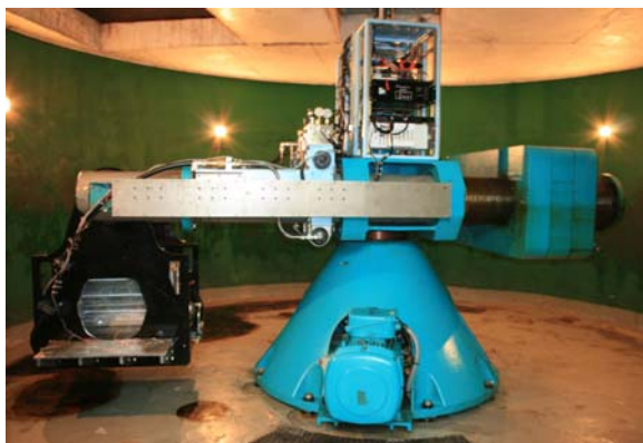
圖 1 中央大學地工離心機暨振動台
