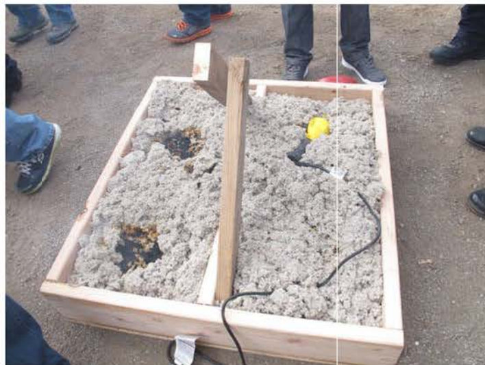
圖 25 棉絮因鎢絲燈泡表面的高溫產生碳化
