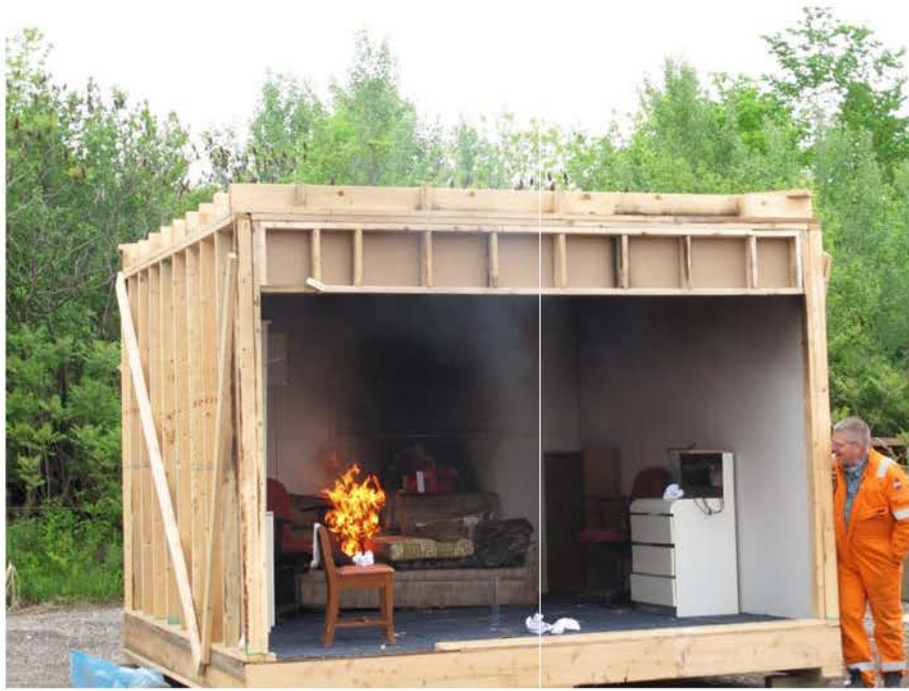
圖 28 全尺寸模擬燃燒實驗
