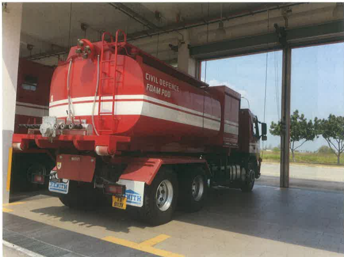
圖 3.19、大流量泡沫原液車（資料來源：本次參訪拍攝照片）
