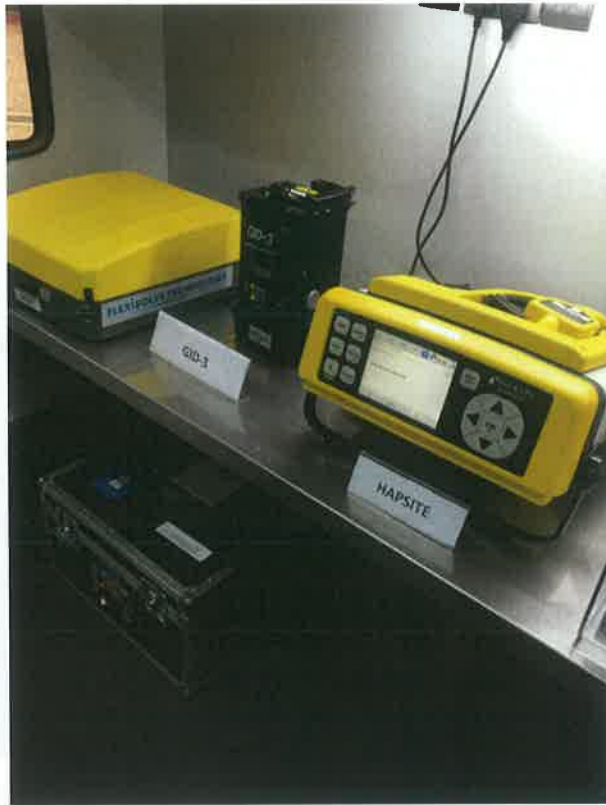
圖 3.12、軍用型化學偵檢器（GID-3）及攜帶型氣相層析儀（HAPSITE）
