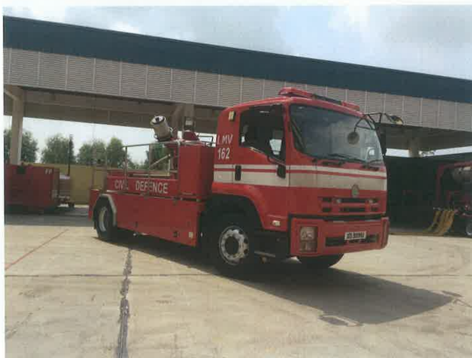
圖 3.17、大流量泡沫砲塔車（資料來源：本次參訪拍攝照片）
