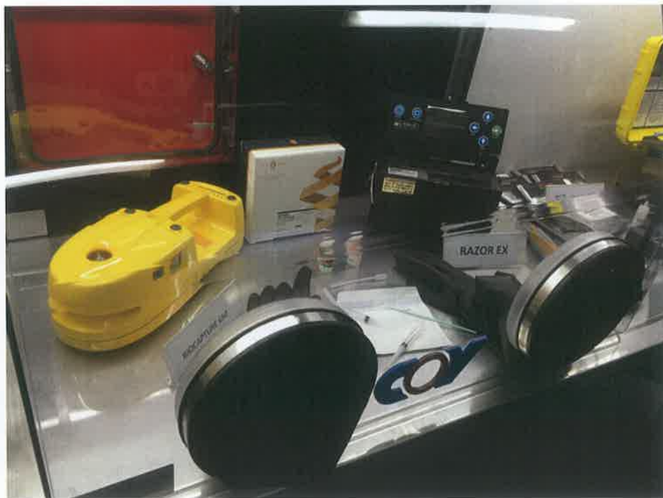
圖 3.13、生物威脅偵測器（BIOCAPTURE【左】及 RAZOR EX【右】），可偵測會造成生物威脅之病菌或病毒（如可偵測炭疽熱、瘟疫……等），及實驗用之操作櫥窗（資料來源：本次參訪拍攝照片）
