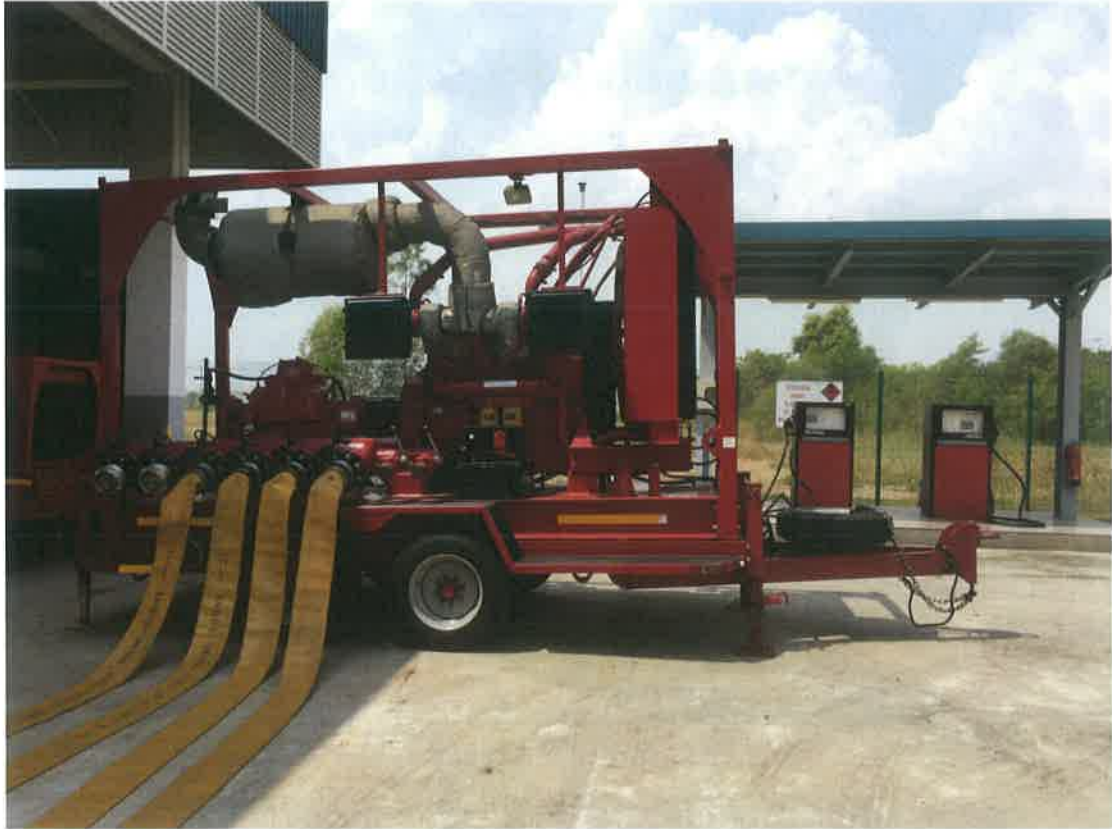
圖 3.18、大流量泡沫幫浦車（資料來源：本次參訪拍攝照片）
