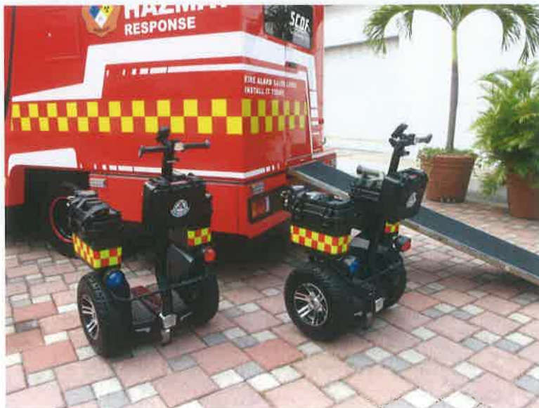
圖 3.6、機動處理車輛，車上配有攜帶型化學物品偵測設備
