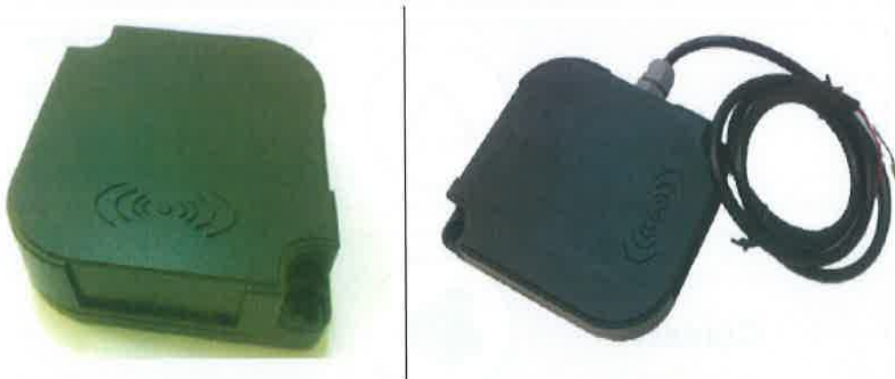
圖 1.3.2、左為發送信號之裝置（裝在拖車上），右為接收器（裝在聯結車上），可由遠端確認聯結車有確實連結
