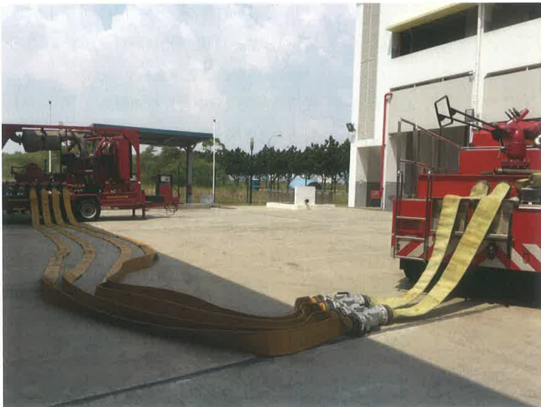
圖 3.21、大流量砲塔車與幫浦車連接（資料來源：本次參訪拍攝照片）
