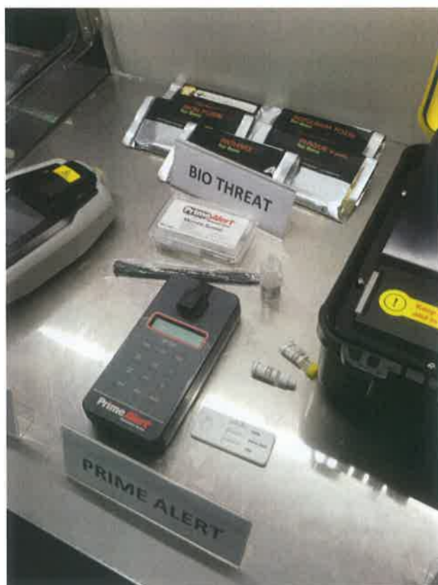
圖 3.11、生物威脅警報器（如可偵測炭疽熱、瘟疫……等），可應付恐怖及生化攻擊（資料來源：本次參訪拍攝照片）
