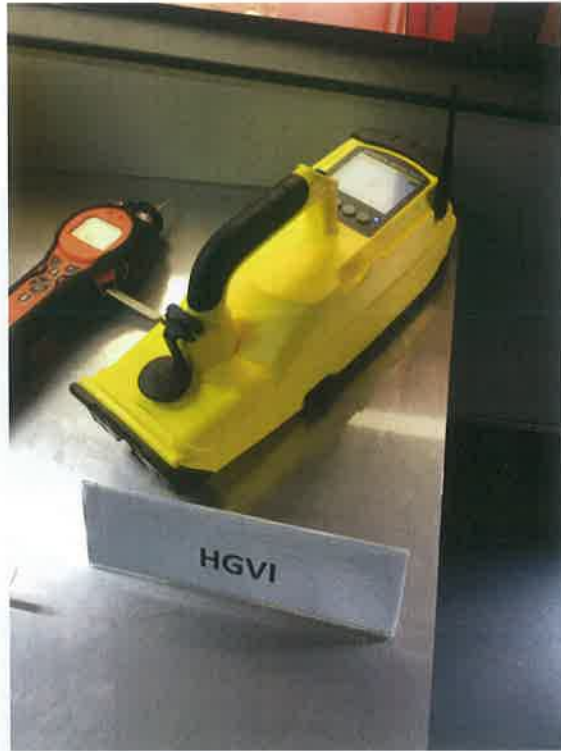
圖 3.8、手提型複合式氣體檢測儀（Hazardous Gas and Vapor Identifier），偵測方式結合電化學、光離子偵測及游離離子光譜儀，並與先進軟體結合，故此儀器靈敏度及準確度高（資料來源：本次參訪拍攝照片）
