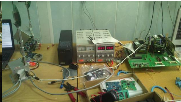
中央大學自製太空器像科學儀器酬載，電控箱本體及光度計感測模組
