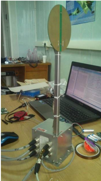
中央大學自製太空器像科學儀器酬載，電控箱本體及光度計感測模組
