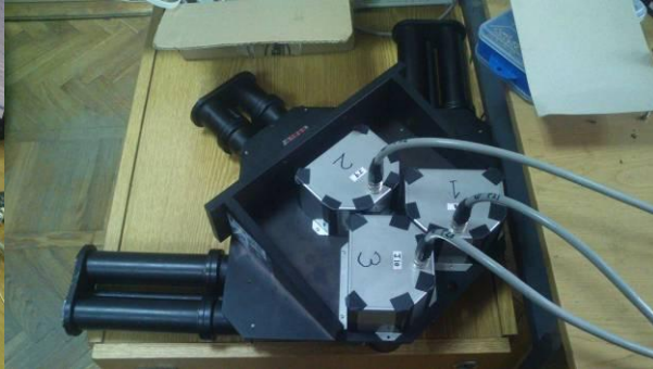
中央大學自製太空器像科學儀器酬載，電控箱本體及光度計感測模組
