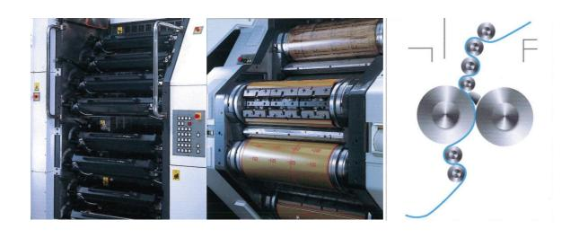
是張頁式雙面多色平凸版印刷機,可同時印刷紙張的正反面,採用 Blanket to Blanket 的壓印印刷方式,兩個橡皮滾筒各自與四塊印版接觸,使用特殊三層軸承來達到超精細線印刷,
