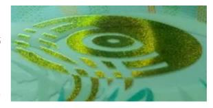
中,創造出類似水印的效果,及其他在傳統鈔券紙基上所看見的其他特徵;在這步驟中,其他特殊的安全油墨也可以透過印刷來達到機器的可閱讀性、隱藏或非隱藏的安全特徵。印製完成的整捲(Polymer substrate)需轉換成單張再供應給鈔券印製廠。
