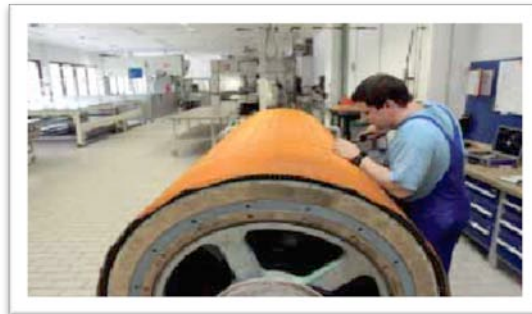
圖 1.1 銅絲網與安裝銅絲網之模鑄水印滾軸
