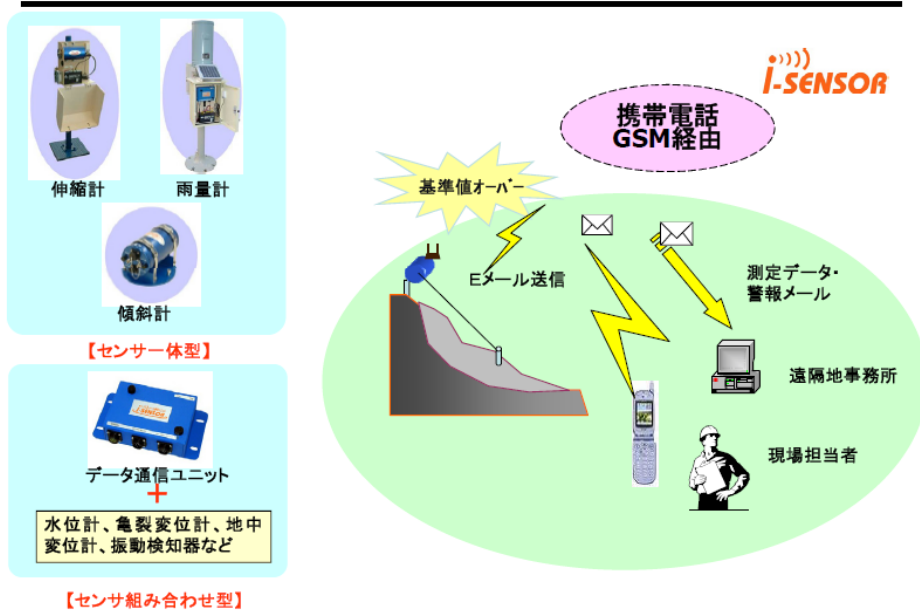
圖 4.7 儀器訊號傳輸方式示意(日本中部電力株式會社)
