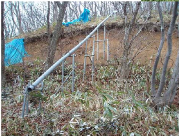
圖 4.1 電子式地表伸縮計(上野将司，觀測及警戒前瞻技術檢討會)
