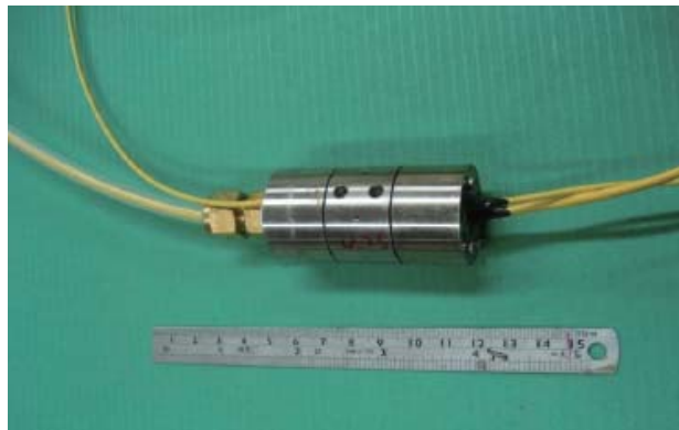
圖5.5光纖光柵水壓計(劉亦強，電力人·第十六期 2014)
