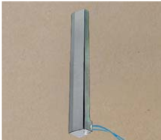
圖 5.3 光纖光柵傾斜儀(劉亦強，電力人·第十六期 2014)
