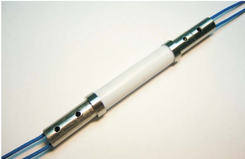
圖5.4光纖傾角計(蔡瑞禎，光纖感測預警系統)
