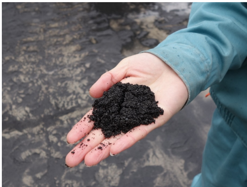
圖 24 大太平洋金屬株式会社廢棄物熔融設施產出熔渣(破碎為混凝土用骨材)
