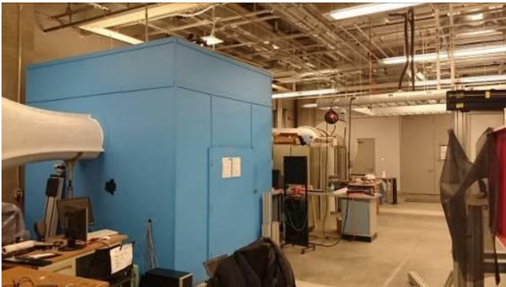
圖 3、密閉式小型風洞
