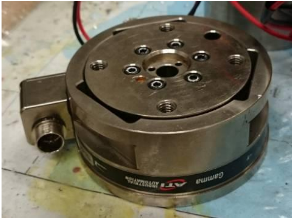
圖 12、ATI Force & Moment Transducer
