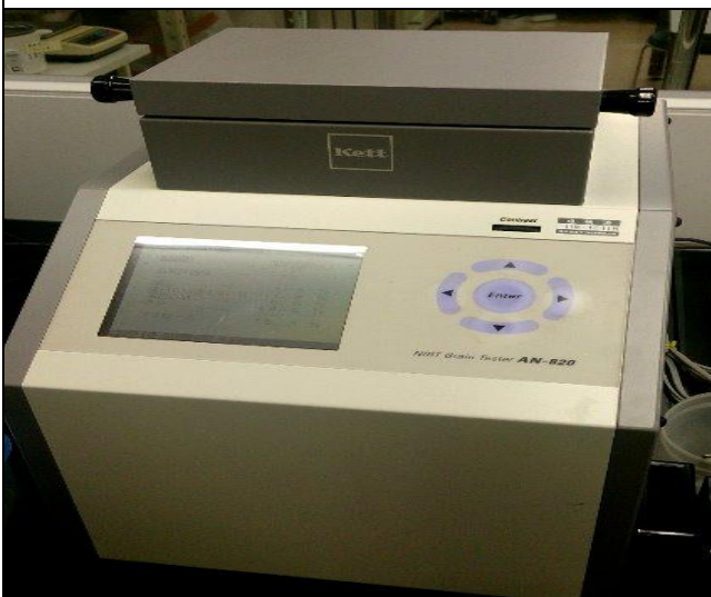
伊藤忠食糧使用 RN-820 型新鮮度測定儀檢測稻米新鮮度
