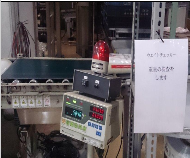
以重量檢測機檢查重量
