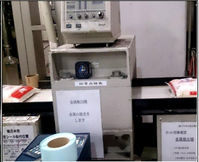
小包裝米以金屬檢測機檢查金屬
