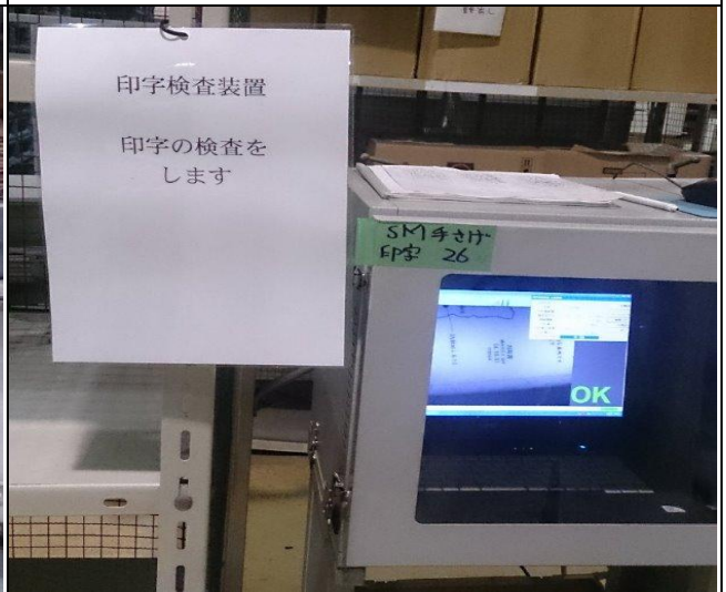
以印字檢查機檢查印刷內容
