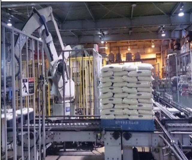
機器人手臂自動將小包裝米堆疊於棧板上
