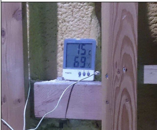
低溫倉庫之溫度控制在攝氏 15°C，濕度 70% 左右
