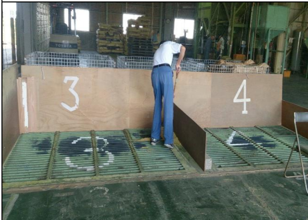
袋井營農中心之3號及4號濕穀入料口
