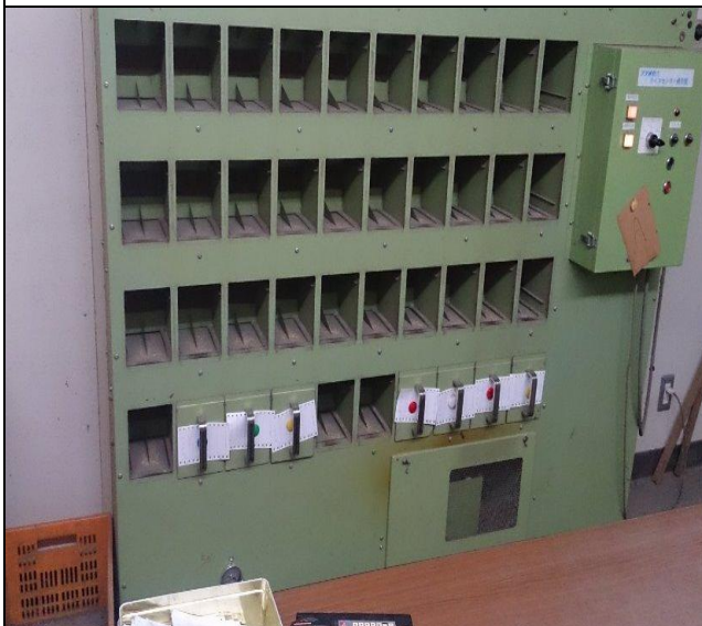
袋井營農中心設有專用濕穀樣品乾燥機，存放取樣之樣品
