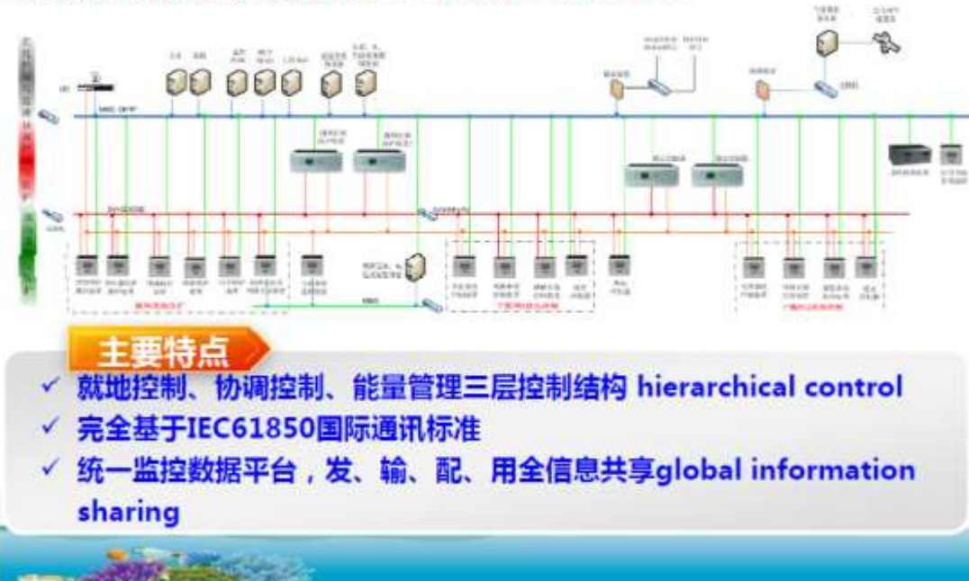
圖16 南麂島微電網控制系統架構
