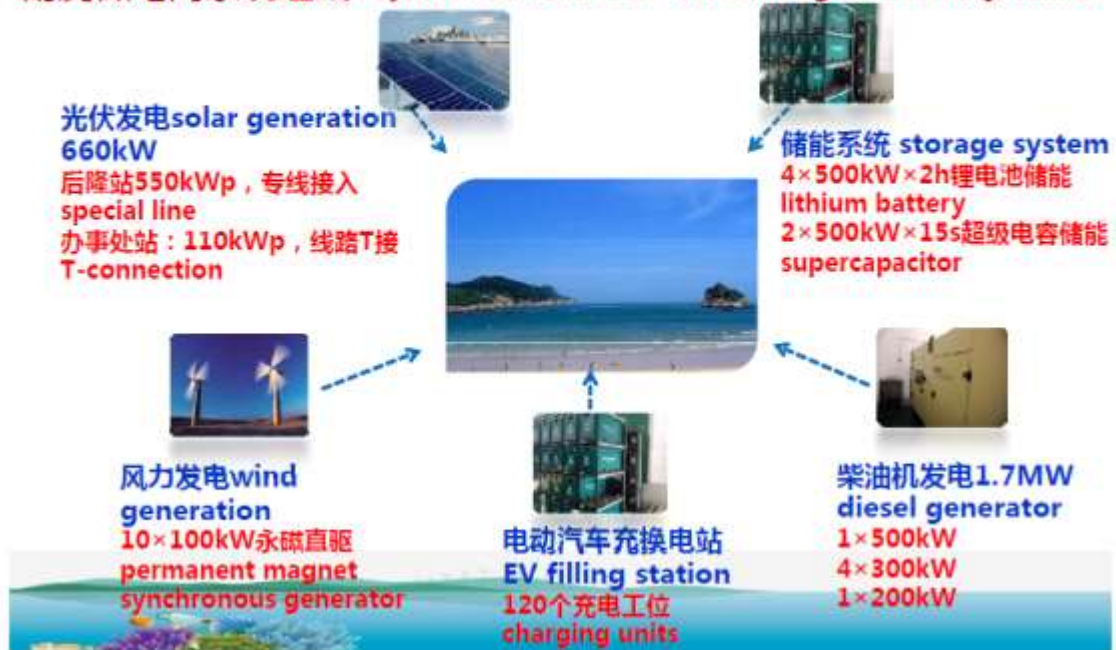
圖12 南麂島微電網系統的組成
