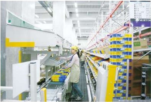
DPS 電子標籤配合流利架揀貨系統
